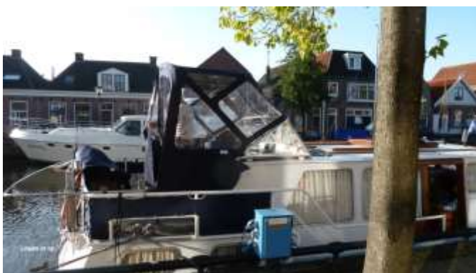
Nieuwe kap plaatsen
